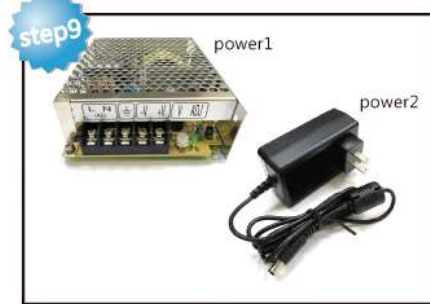
step9 取出所附配件包內的變壓器。其中A2連板適用power1 其中A3及A4連板適用power2
