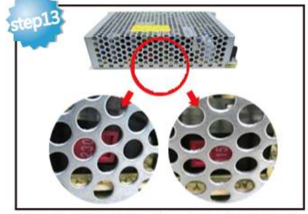
step13 電源供應器安裝完成後，側邊的開關要和實際使用電壓(110v 或 220v)相同方能正常通電。
