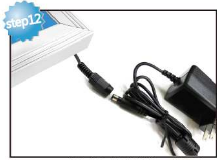
step12 power2 · 直接公母端子對接，並插入110/220V插座即完成。
