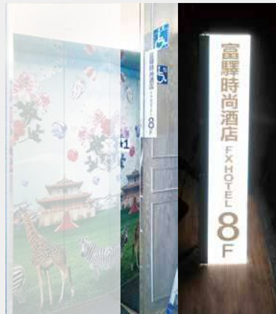
▲ 鐵件搭配 燈箱與鐵架的結合，鐵櫃厚度僅約 3 公分。
